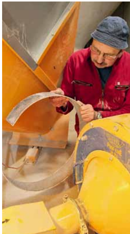
Das Sieb der Hammermühle wird regelmäßig kontrolliert und bei Bedarf ausgetauscht.
