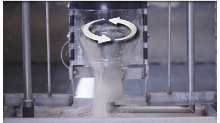
Automatische Fütterung wenn der Sensor leer meldet
