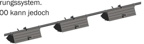
Max. 20 Stück VD100 pro Seil 3 mm. Das Futter wird ca. 1,5 Meter breit auf dem Boden verteilt, abhängig von der Montagehöhe.
