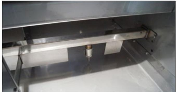
Das Trinkwasser für die Schweine kommt aus Druckventilen im Trog.
