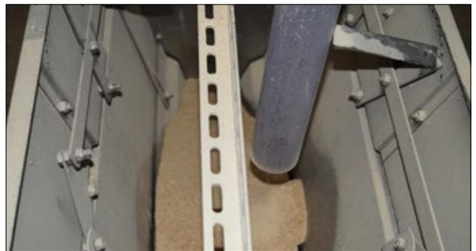
Das Futter kommt direkt aus dem Fallrohr in den Automaten.
