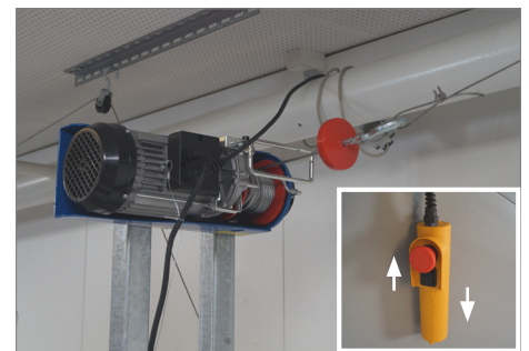
Elektrischer Motor für Zentralabhebung
